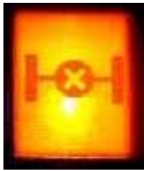
Témoin de blocage de différentiel de pont Avant Renault trucks M 210
