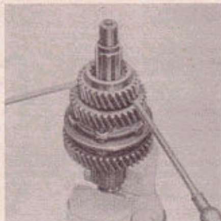
Dépose du pignon de 4 e de son jonc d'arrêt et de sa rondelle d'appui.
