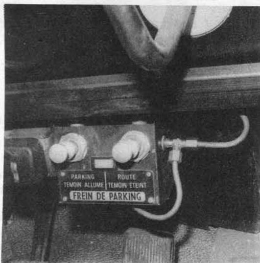
Fig. 83 — COMMANDE MANUELLE DE FREIN DE STATIONNEMENT (MICRO-VALVES).
