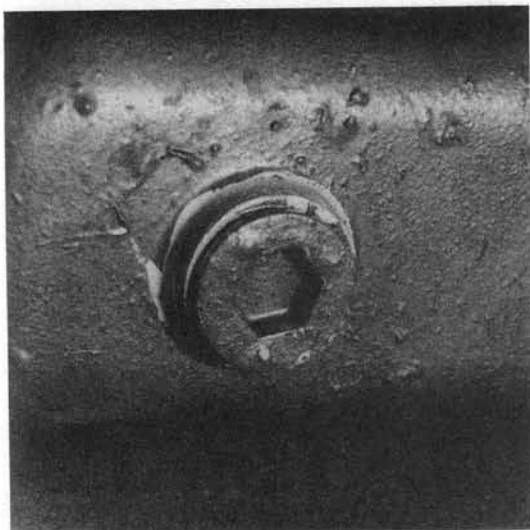
Fig. 130 — BOUCHON DE VIDANGE DE CARTER MOTEUR.
