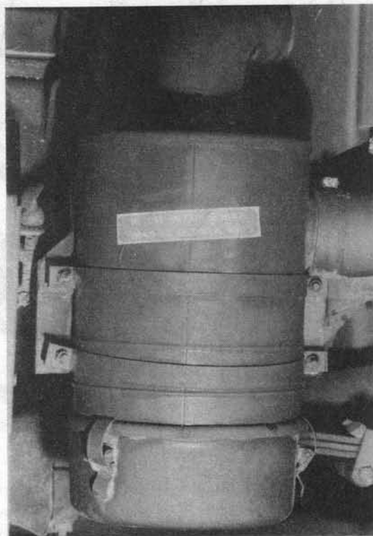
Fig. 20 — FILTRE D'AIR.
