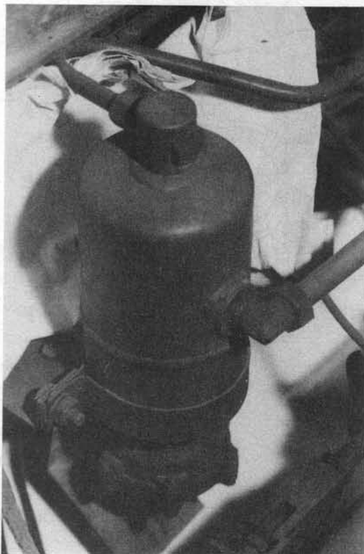
Fig. 60 — EPURATEUR D'AIR.
