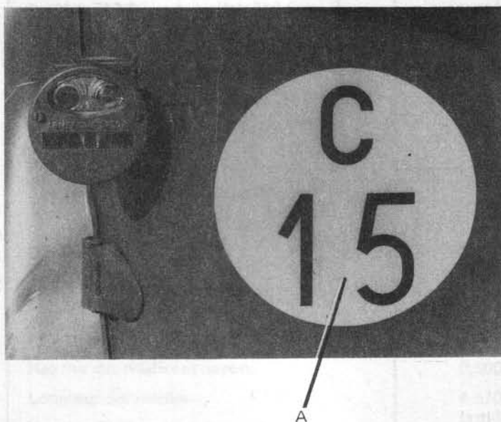
Fig. 9 — CLASSE DE PONT POUR VEHICULE TRACTANT UNE REMORQUE.
